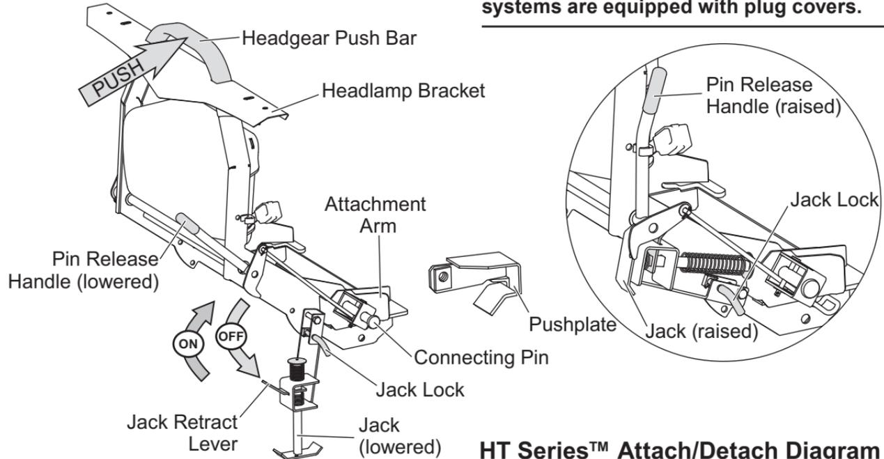
**HT Series™ Attach/Detach Diagram**
